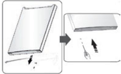
8. Zet de deur van de koelkast overeind, draai het middelste deurscharnier 180° en monteer dan aan de tegenovergestelde kant van het apparaat. Bevestig het middelste deurscharnier met de bijbehorende schroeven.
