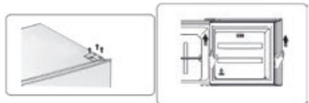
3. Lösen Sie die Schraube am Türgelenk und schrauben Sie sie auf der anderen Seite des Gelenks wieder fest.
