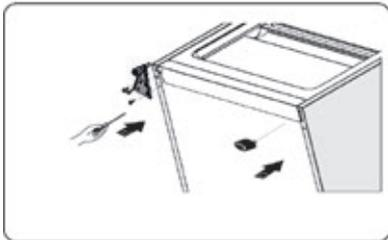
7. Enlevez les bouchons en plastique et la vis du dessous de la porte du réfrigérateur et remettez-les en place de l'autre côté de la porte.
