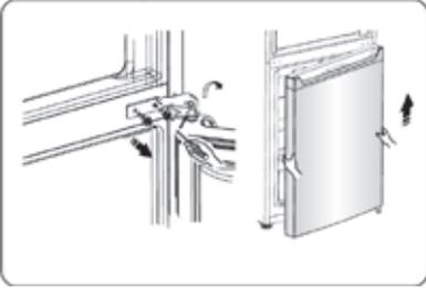
5. Ôtez le cache en plastique de l'un des côtés de l'appareil et remettez-le en place de l'autre côté.
