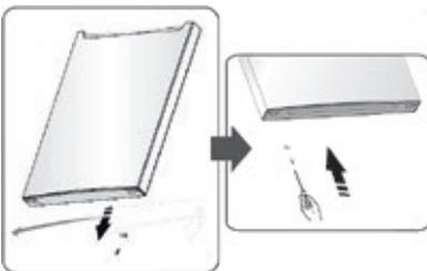
8. Setzen Sie die Kühlraumtür auf, drehen Sie das mittlere Türgelenk um 180° und montieren Sie es dann an der gegenüberliegenden Seite des Gerätes. Befestigen Sie das mittlere Türgelenk mit den zugehörigen Schrauben.
