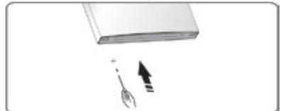
10. Setzen Sie die Gefrierraumtür auf und montieren Sie das obere Türgelenk an der gegenüberliegenden Seite des Gerätes. Befestigen Sie das obere Türgelenk mit den zugehörigen Schrauben.
