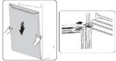
9. Lösen Sie den Kunststoffstopfen und die Schraube an der unteren Seite der Gefrierraumtür und schrauben Sie sie an der anderen Seite der Tür wieder an.
