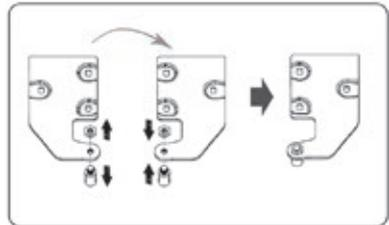
4. Lösen Sie die Schrauben, die das mittlere Türgelenk halten und entfernen Sie dann das mittlere Türgelenk. Heben Sie die Kühlraumtür ca. 50 mm an, um sie abschließend vom Gerät abzunehmen.
