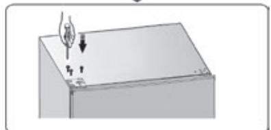
11. Setzen Sie die separat beiliegende Türgelenk-Abdeckung auf das obere Türgelenk. Setzen Sie die Kunststoffabdeckung auf der gegenüberliegenden Geräteoberseite ein.
