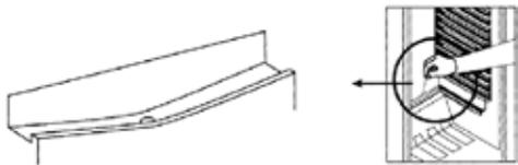
Veillez à ce que le canal et le trou d'écoulement ne soient pas bouchés afin que l'eau produite dans la chambre froide puisse toujours s'écouler librement.
