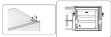
3. Draai de schroef van de deurscharnier los en schroef aan de andere kant van de scharnier weer vast.
