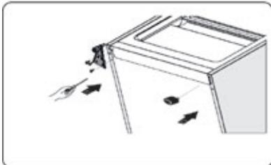
7. Draai de kunststof stoppen en de schroef aan de onderkant van de deur van de koelkast los en schroef aan de andere kant van de deur weer vast.
