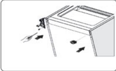
7. Lösen Sie den Kunststoffstopfen und die Schraube an der unteren Seite der Kühlraumtür und schrauben Sie sie an der anderen Seite der Tür wieder an.
