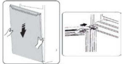
9. Verwijder de kunststof stoppen en de schroef aan de onderkant van de vrieskastdeur en schroef aan de andere kant van de deur er weer aan.
