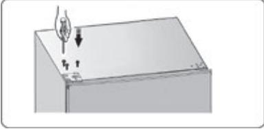
11. Breng het apart bijgevoegd klepje van de deurscharnier op het bovenste deurscharnier aan. Bevestig het kunststof klepje op de tegenovergestelde kant van het apparaat.
