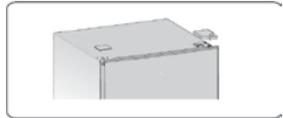
2. Draai de schroeven los waarmee het bovenste deurscharnier vastzit en verwijder deze. Til de vrieskastdeur ongeveer 50 cm op en haal vervolgens van het apparaat.
