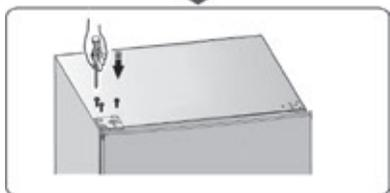
11. Remettez le cache-charnière fournis séparément sur la charnière supérieure de la porte. Remettez le cache en plastique sur le côté opposé du dessus de l'appareil.
