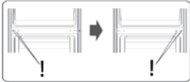
6. Basculez l'appareil légèrement vers l'arrière et dévissez les vis qui maintiennent en place la charnière inférieure de la porte. Dévissez les socles réglable et les vis d'à côté et revissez-les tous les deux de l'autre côté de l'appareil.
