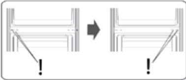
6. Kantel het apparaat een beetje naar achteren en verwijder de schroeven waarmee de onderste deurscharnier vastzit. Verwijder de verstelbare pooten en de schroeven ernaast van het apparaat en schroef beide aan de andere kant weer vast.
