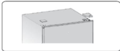
2. Lösen Sie die Schrauben, die das obere Türgelenk halten und nehmen Sie es ab. Heben Sie die Gefrierraumtür ca. 50 mm an, um sie abschließend vom Gerät abzunehmen.
