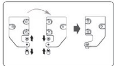
4. Draai de schroeven los waarmee het middelste deurscharnier vastzit en verwijder vervolgens het middelste deurscharnier. Til de deur van de koelkast ongeveer 50 cm op en haal daarna van het apparaat.
